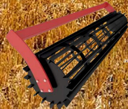
Der Aufbau der Walze ähnelt dem der Rohrstabwalze und besteht aus quer angeordneten Fachstahlgruppen mit glatter bzw. gezackten Kante. Sie hat relativ kleines Gewicht, ist universell einsetzbar und zeichnet sich durch gute Brechleistung und Einebnung der Bodenoberfläche aus.
