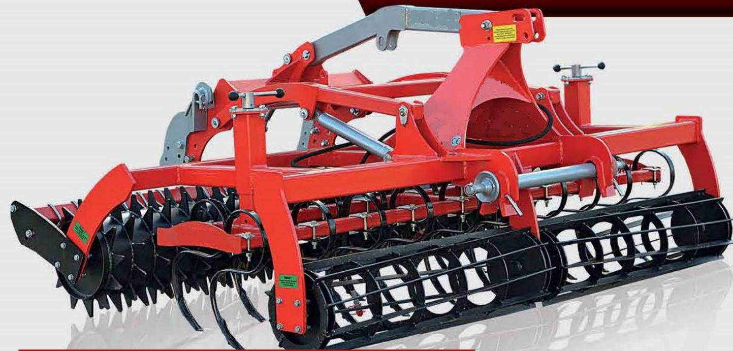
Zwei Zahnreihen, Hydropack an zwei Zylindern, hintere Rohrstabwalze, vordere Krümelwalze, Pulverlackierung.
