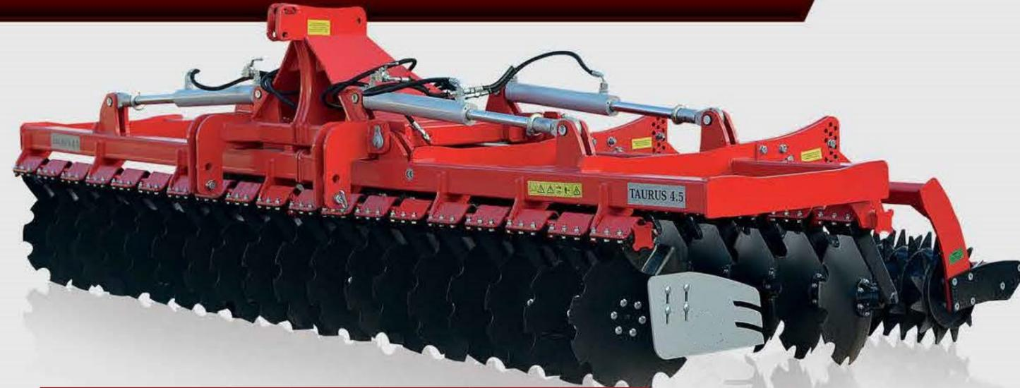
Zwei Scheibenreihen Ø560mm, Gummipuffer, Rohrstabwalze, Seitenbleche, Pulverlackierung, Scheibenreihenabstand 85-90 cm.
