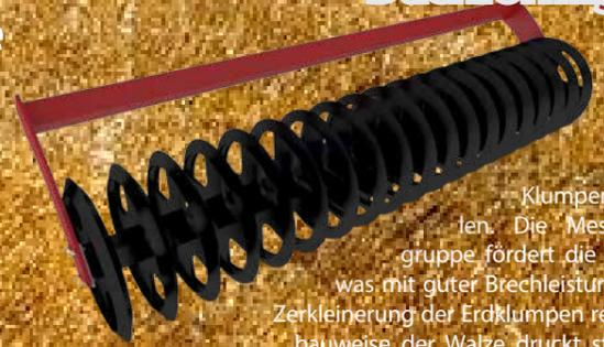
Der Einsatz der dachförmigen Walze wird besonders für Böden mit Tendenz Klumpenbildung empfohlen. Die Messerabstreifer-Baugruppe fördert die Arbeit der Ringe, was mit guter Brechleistung und intensiver Zerkleinerung der Erdklumpen resultiert. Die Ringbauweise der Walze drückt streifenförmig den Boden und bessert so erheblich die Wasserinfiltration in den Boden. Walzenbreite bei 3 Meter Breite beträgt ca. 220kg.
