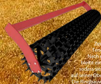
Der Einsatz dieser Walze wird besonders zur Zerkleinerung von Böden mit Tendenz zur Klumpenbildung. Nach dem Durchgang der Walze bleibt ein Streifen lockeren Bodens, sodass sie auch verhindert, dass sich auf seiner Oberfläche eine Schale bildet. Die Ringbauweise schützt die Walze vor Verstopfen. Die Walzenbreite bei 3 Meter Breite beträgt ca. 420kg.
