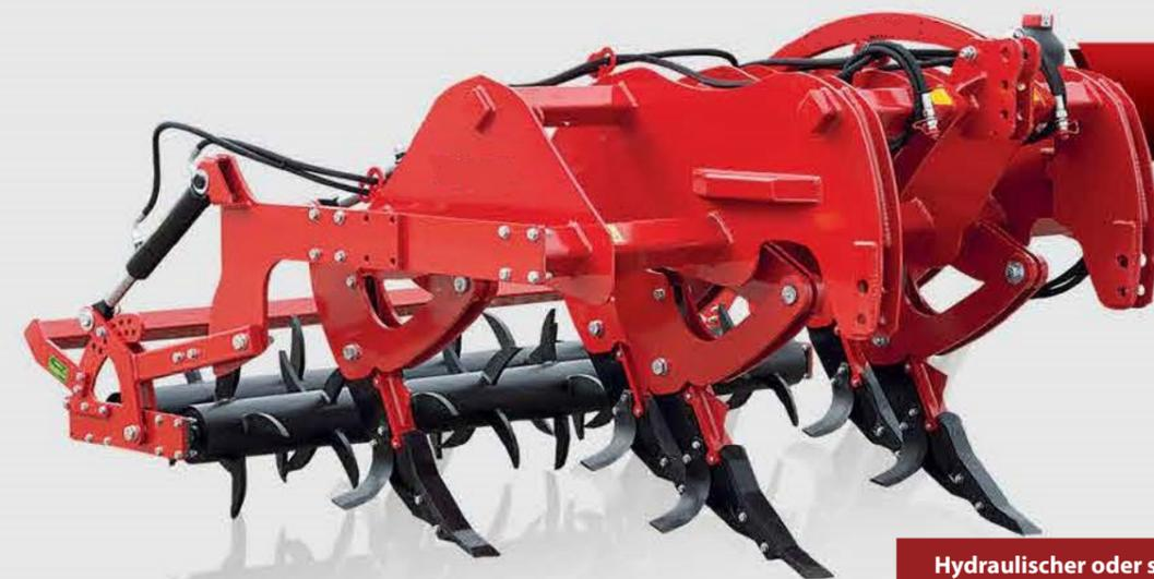
Der Meißelpflug unserer Produktion kann sogar auf einer Tiefe von bis zu 60 cm arbeiten, was die Auflockerung der Unterschicht ermöglicht. Dadurch werden die Wasserinfiltration und die Bodenatmung verbessert, was zur Revitalisierung des gesamten Bodens und schnellerem Pflanzenwachstum führt. Die spezielle Form der Zähne ermöglicht die gleichzeitige Bearbeitung der Ackerfläche und Mischung von Ernterückständen.
